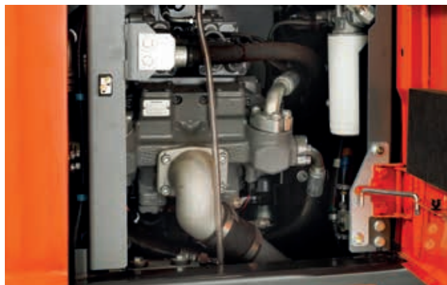
Het HIOS V hydraulische systeem biedt tot 5 % brandstofbesparing (ZX150W-7 en ZX155W-7).
